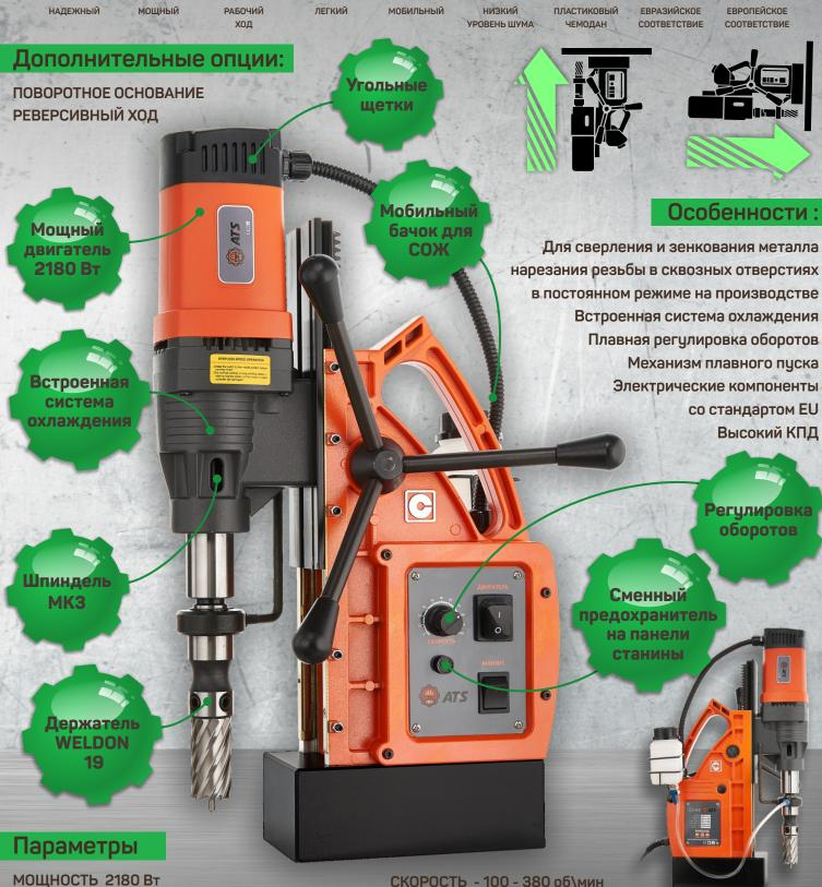
СВЕРЛЕНИЕ КОРОНЧАТЫМ СВЕРЛОМ - ДО 98 ММ СВЕРЛЕНИЕ СПИРАЛЬНЫМ СВЕРЛОМ - ДО 32 ММ ШПИНДЕЛЬ Конус Морзе №3 СТАНДАРТНЫЙ ДЕРЖАТЕЛЬ - Weldon 19
